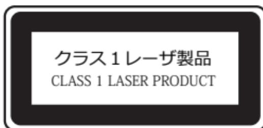
この製品は IEC60825-1:2014 規格に基づいた「クラス 1 レーザ製品 (CLASS 1 LASER PRODUCT)」です。この製品は波長 940nm の赤外線レーザーを使用しております。ご使用の際は、本書の指示を守ってご使用になる限りは、ご使用のどの段階においてもクラス 1 の被ばく放出限界を超えるレーザー放射は行われません。
